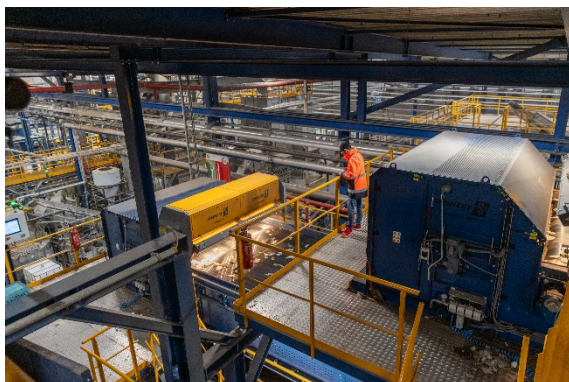
Légende photo : Vue de l'usine Cirrec : plusieurs systèmes de tri par capteurs et séparateurs magnétiques STEINERT nettoient et trient les barquettes en PET de manière automatisée. Photo : STEINERT GmbH
