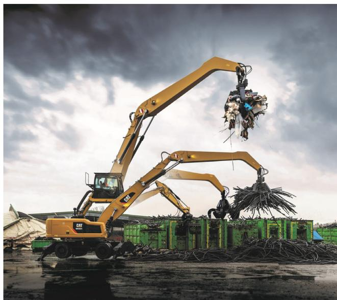
Chaque machine vendue par Bergerat Monnoyeur en France intègre, au standard, un pack industriel Recyclage et Déchets comprenant ventilateur réversible, préfiltre à air cyclonique et grille de protection de radiateur vibrante (exclusivité CAT Brevetée). Côté équipements, avec les Gammes CAT de Grappins GSH/GSV et de Pinces de Tris pour Démolition ou Recyclage, il y a forcément l'Outil CAT idéal pour toutes les Pelles de Manutention.
